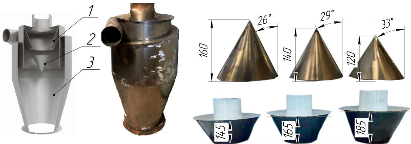
Рисунок 8 – Общий вид двухступенчатого циклона:
