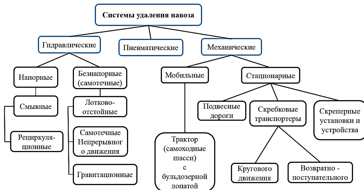
Рисунок 1.1 – Системы удаления навоза из свиноводческих помещений
