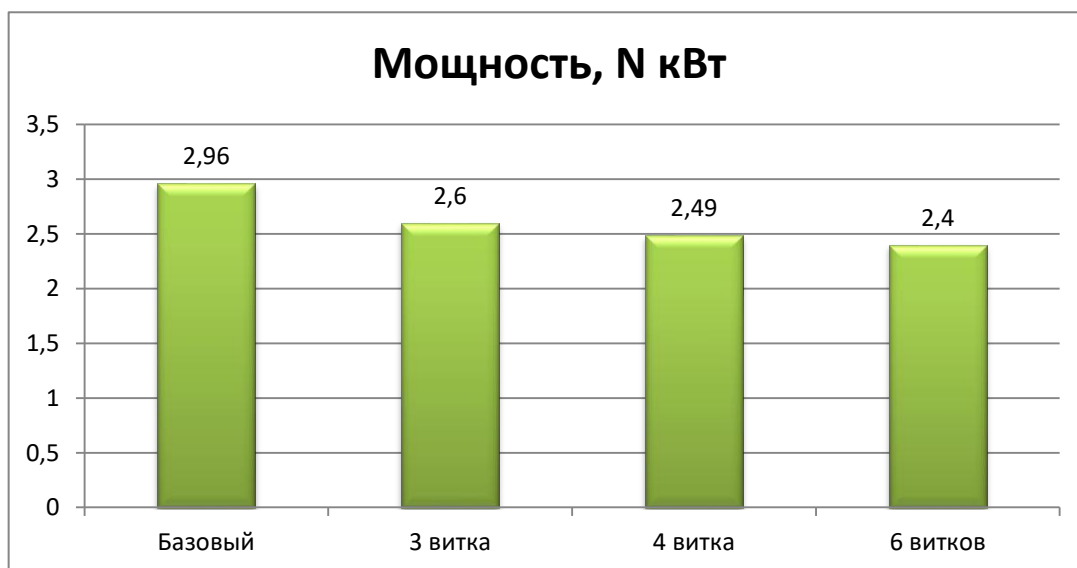
Рисунок 4.7 – График изменения мощности молотковой дробилки ДПМ-11 с пневмосепаратором [24]
