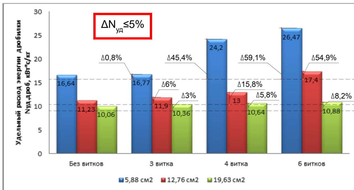
Рисунок 4.9 - График зависимости изменения удельного расхода энергии дробилки от площади открытия заслонки и количества витков винтового рабочего органа [31]
