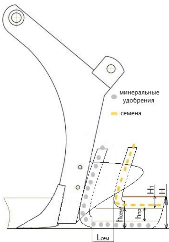
Рисунок 2.8 – Конструктивно-технологическая схема работы комбинированного сошника
