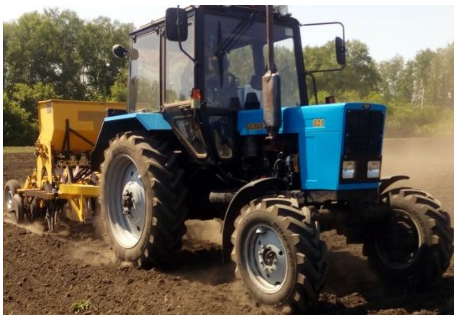
Рисунок 4.9 –Трактор МТЗ-82 в агрегате с экспериментальной сеялкой-культиватором СКП-2.1
